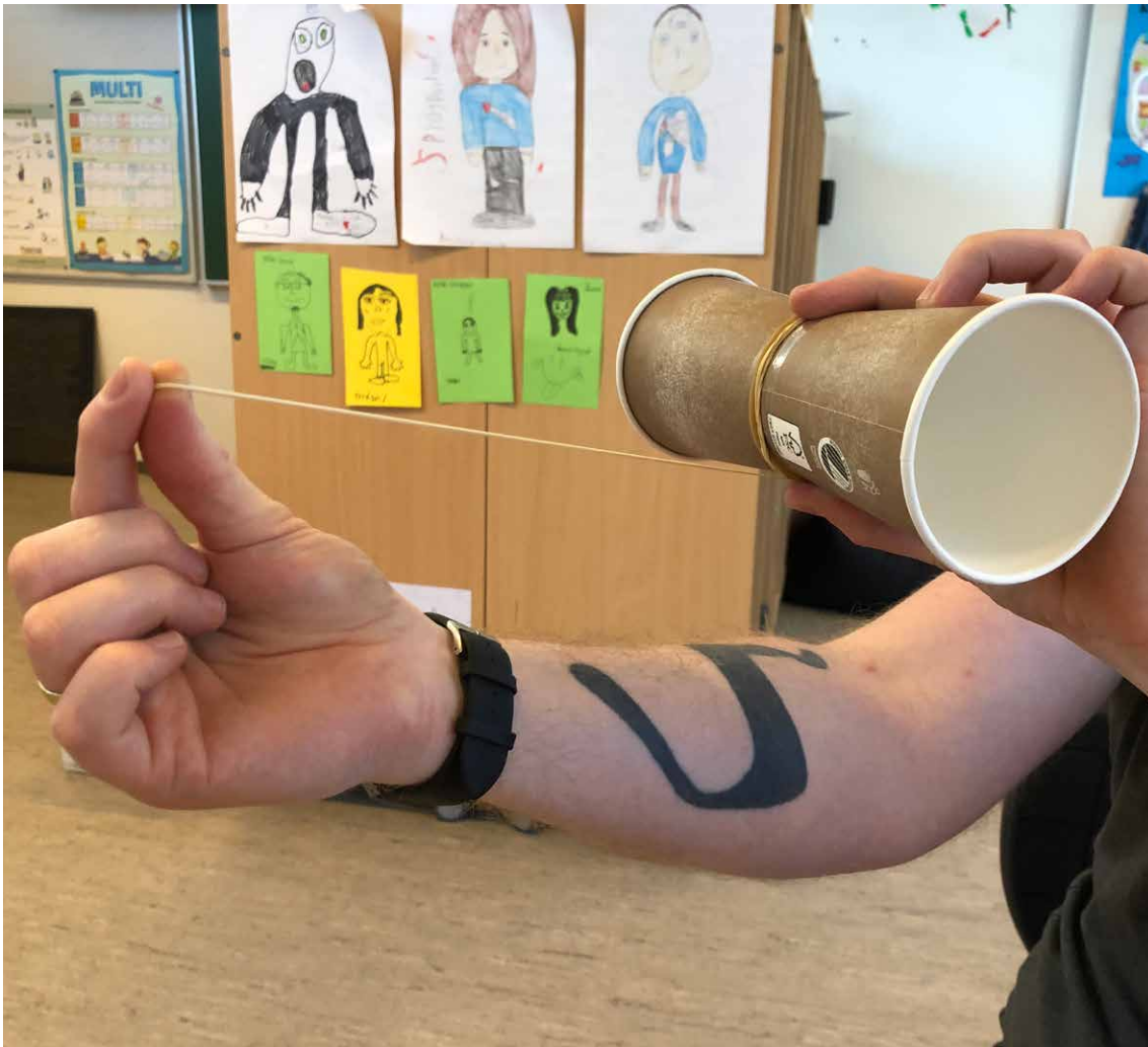
Billede 1: Sammentapede kaffekrus og affyring via omviklede elastikker. Foto: Mette-Maria Rydén. Model: Kim Froulund Gøttler
